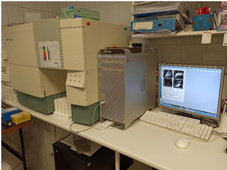
Becton Dickinson FACSCalibur fluoreszcens áramlási citométer: 2 lézerrel (488 nm, 633 nm) rendelkező analizátor
